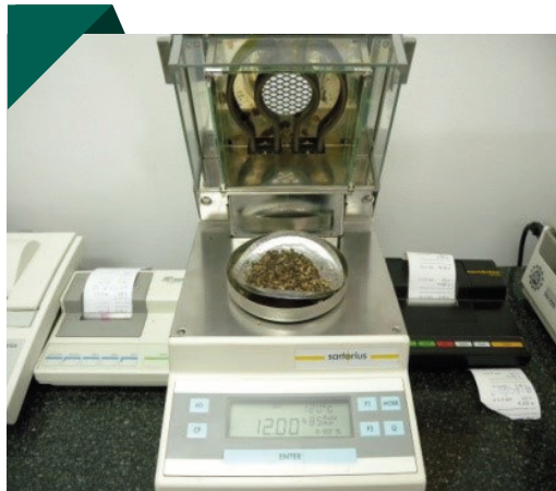
Pomiar wilgotności - metoda wagosuszkowa. Fot. Dagmara Topola
