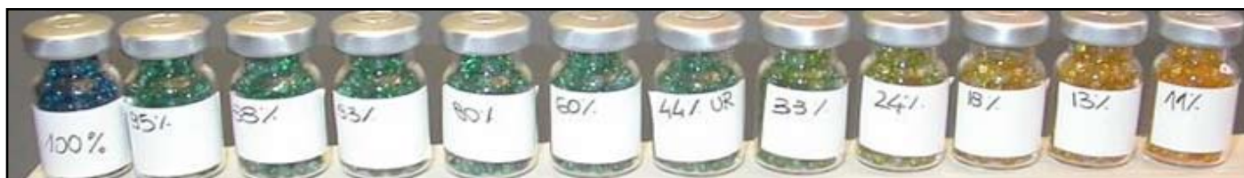
Rycina 14 Silica gel hydration series. Stany nawodnienia żelu krzemionkowego. Nawodnienie pełne do częściowego (od lewej do prawej) (© MTSN)
