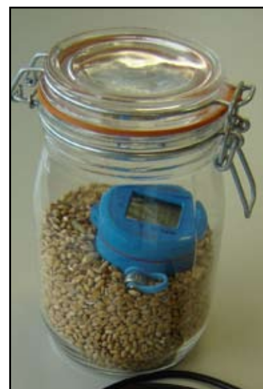
Rycina 16 Rejestrator eRH w zamkniętym pojemniku z nasionami. (© RBGK)
