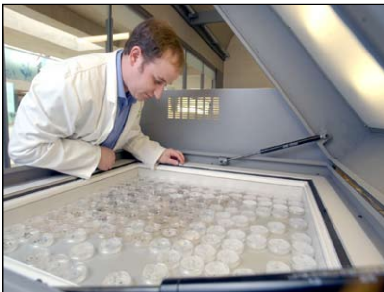
Rycina 23. Inkubator naśladujący warunki świetlne dnia i nocy. (© RBGK)
