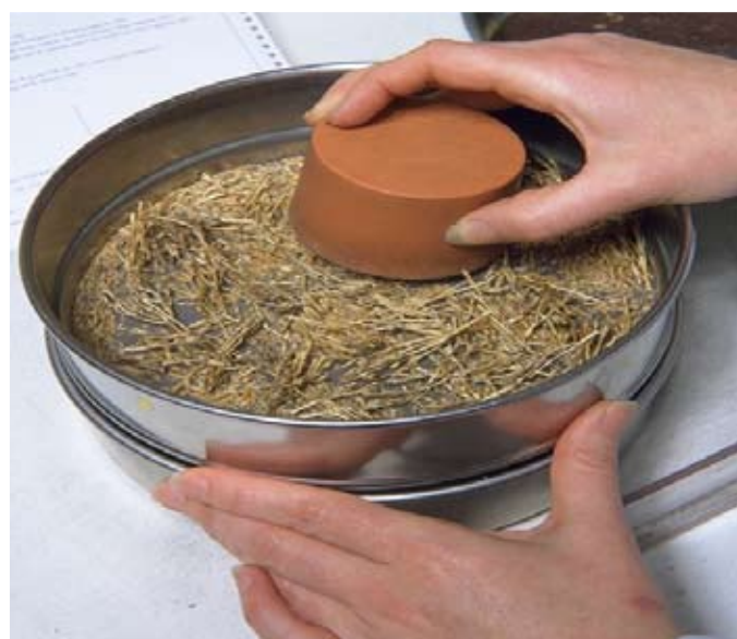
Rycina 5 Czyszczenie nasion z zastosowaniem sita i zatyczki gumowej. (© RBGK)
