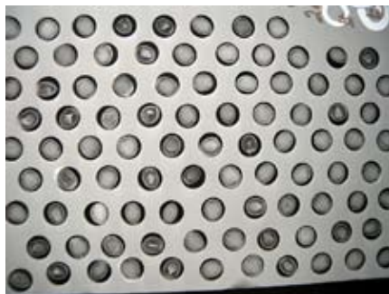
Fot. 66. Przykład prześwietlenia nasion cisa pospolitego metodą RTG
